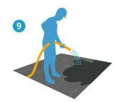
Finalizado el proceso de compactación, es necesario mantener la humedad de la superficie ejecutada mediante geotextil o arpillera húmeda y riego pulverizado, durante un mínimo de 24 horas. Siempre se cuidará de no lavar la superficie recién compactada.
