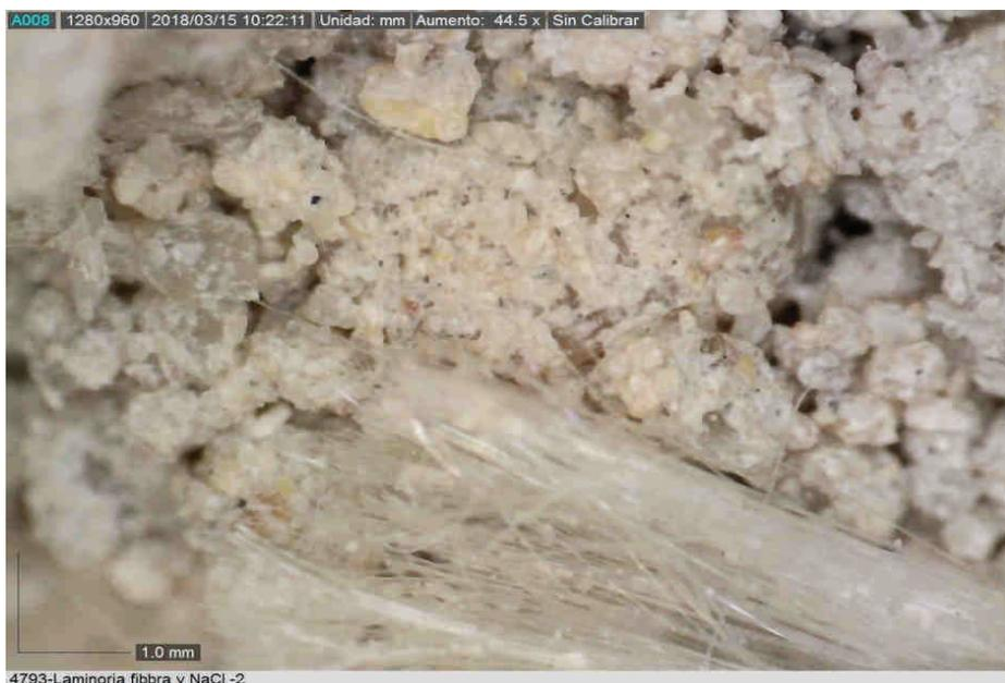
Imágenes a 42 aumentos de las roturas de las probetas de ref. 4791 -4792 y 4793, fabricadas con arena 0/4 Laminoria y 9% de ESTABEX. Sometidas al ensayo de niebla salina hasta rotura a 28 días, en las que se aprecian en detalle, las fibras aportadas.
