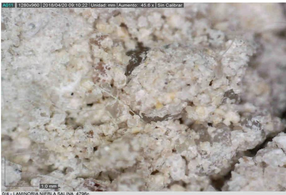
Imágenes a 24 y 40 aumentos de las roturas de las probetas de ref. 4789 y 4796, fabricadas con arena 0/4 Laminoria y 9% de ESTABEX. Sometidas al ensayo de niebla salina hasta rotura a 64 días, en las que se aprecian, en detalle, las fibras aportadas.
