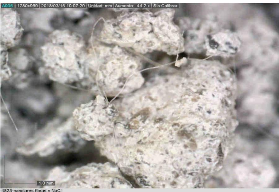
Imágenes a 42 aumentos de las roturas de las probetas de ref. 4821 -4822 y 4823, fabricadas con arena 0/4 Nanclares y 9% de ESTABEX. Sometidas al ensayo de niebla salina hasta rotura a 28 días, en las que se aprecian las fibras aportadas .
