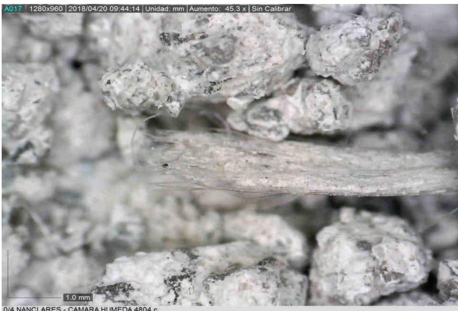
Imágenes a 10 - 20 y 40 aumentos de las roturas de las probetas de ref. 4804 y 4826, fabricadas con arena 0/4 Nanclares - 6,5 y 9% de ESTABEX. Sometidas al ensayo de niebla salina hasta rotura a 64 días, en las que se aprecian, en detalle, las fibras aportadas.
