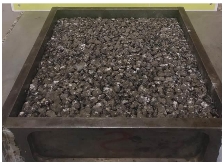
Imagen nº3. Extensión del RAP en la probeta y posterior compactación.
