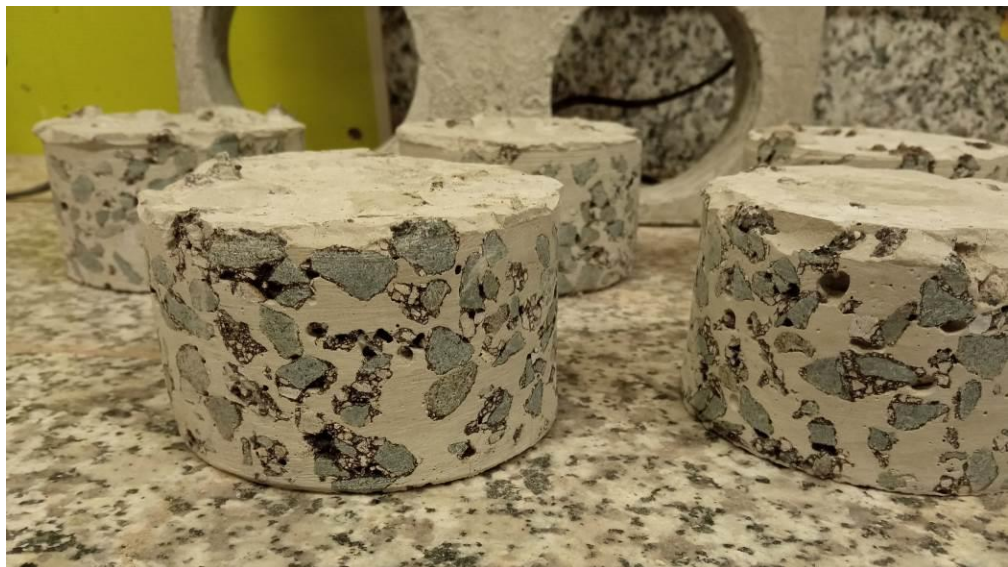
Imagen nº6. Probetas testigo del RAPCARGO sin compactar.
