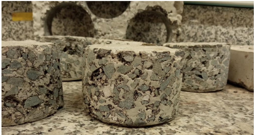
Imagen nº7. Probetas testigo del RAPCARGO compactado.
