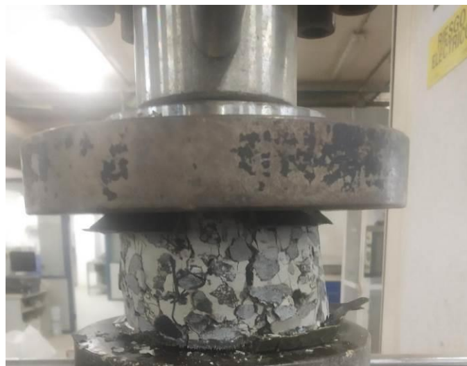
Imagen nº8. Ensayo a compresión de una de las probetas testigo.
