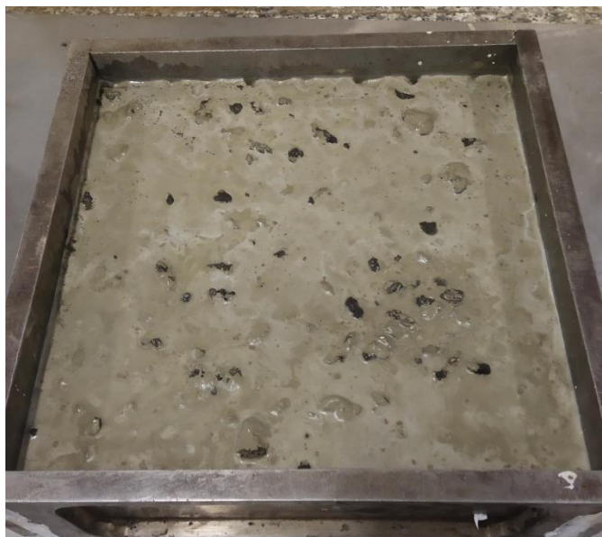
Imagen nº2. Percolado del RAP sin compactar
